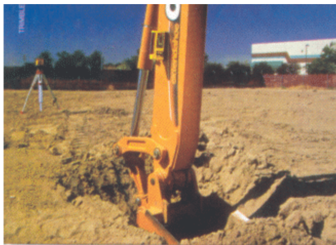
Máy thu được liên kết bằng từ tính hoạt động khi hố đào đạt cấp với tín hiệu LED màu xanh
